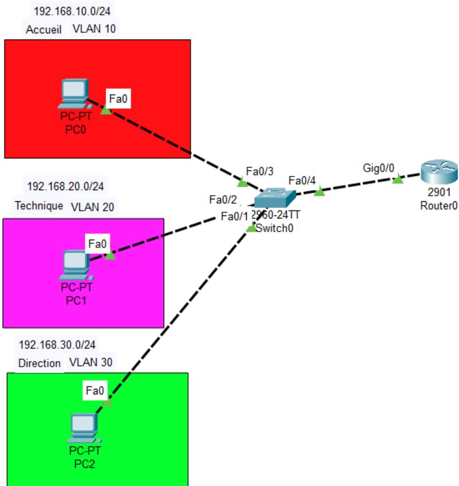
Topologie simulée reliant trois VLANs (**Accueil** 192.168.10.0/24, **Technique** 192.168.20.0/24, **Direction** 192.168.30.0/24) via un trunk 802.1Q vers un routeur en router-on-a-stick afin d'assurer le routage inter-VLAN et permettre à tous les postes de communiquer et de se pinguer.
