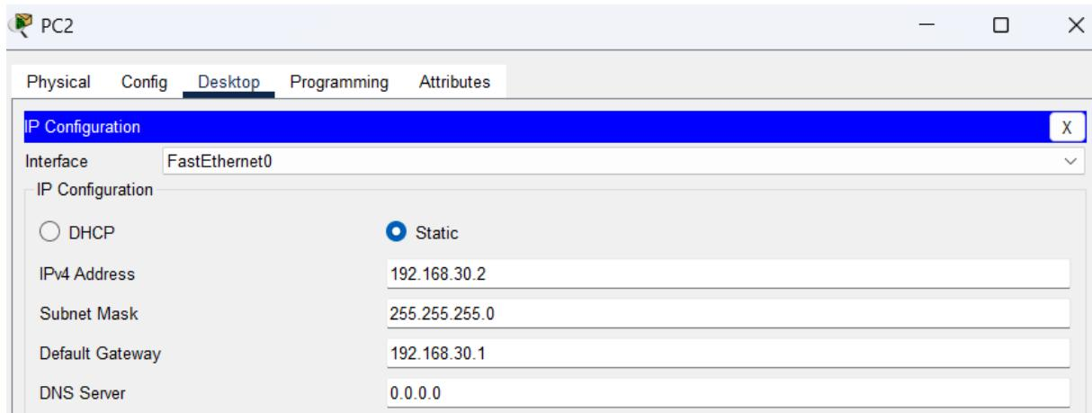
PC2 (VLAN 30 — Technique) : IP statique 192.168.30.2 / Masque 255.255.255.0 — Passerelle 192.168.0.1
