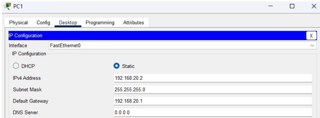
PC1 (VLAN 20 — Technique) : IP statique 192.168.20.2 / Masque 255.255.255.0 — Passerelle 192.168.20.1
