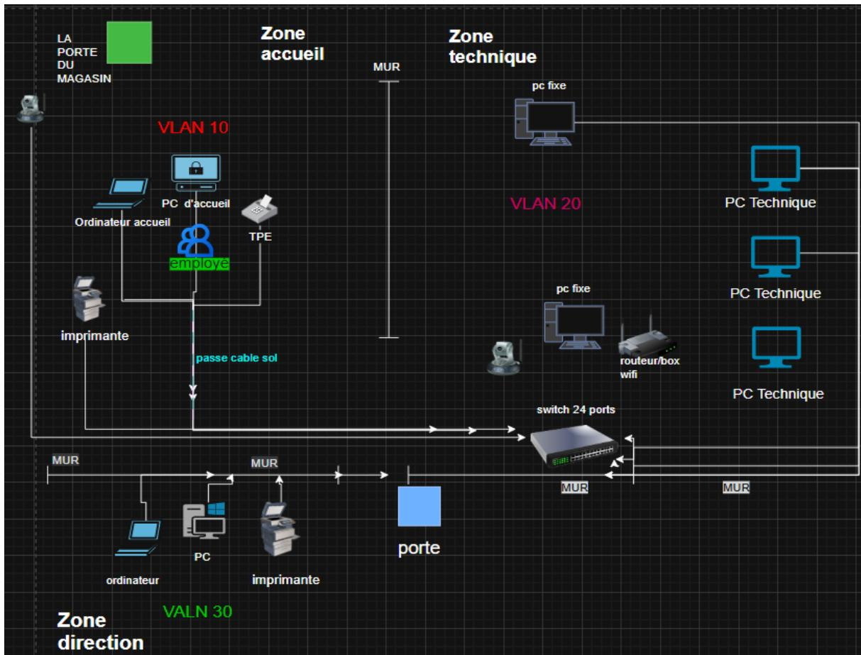
Le réseau proposé repose sur un switch Cisco 24 ports, qui devient le point central de l'infrastructure. Tous les équipements de l'entreprise sont connectés à ce switch à l'aide de câbles RJ45 protégés et organisés.
